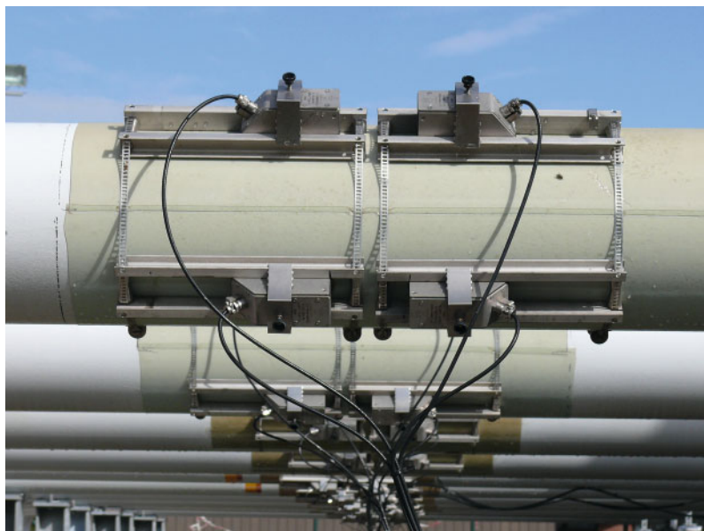
Bild 2. Messstellen mit den in Kreuz-Reflex-Anordnung angebrachten Clamp-On-Ultraschallsensoren.
